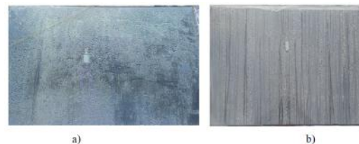
Gambar 5. Permukaan penutup, a) penutup tanpa nano coat, b) penutup dengan nano coat
