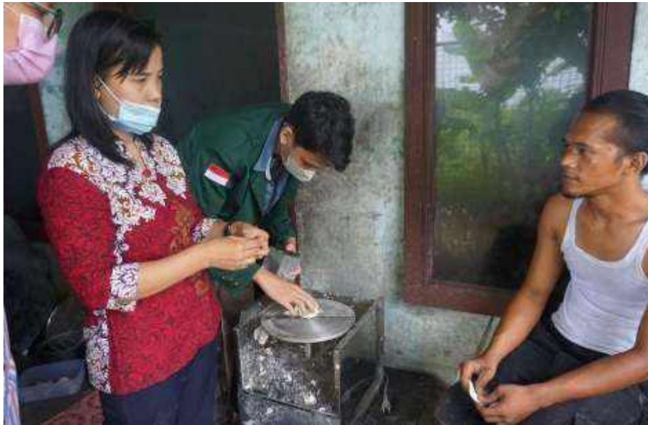
Gambar 15. Kegiatan pengaturan letak pisau untuk ketebalan irisan ubi kayu
