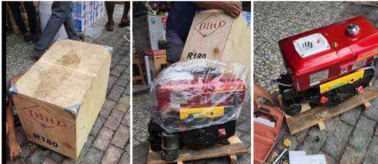
Gambar 4. Mesin penggerak alat pemipil berkekuatan 8 PK yang digunakan
