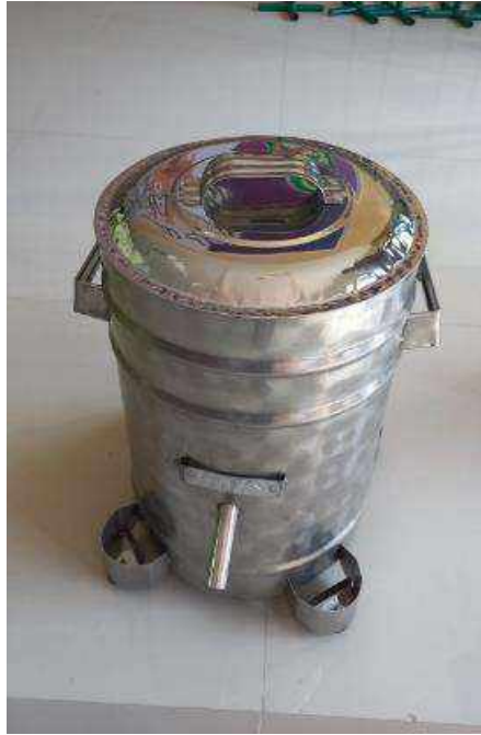
Gambar 5. Mesin peniris minyak ( spinner ) kapasitas 3 kg
