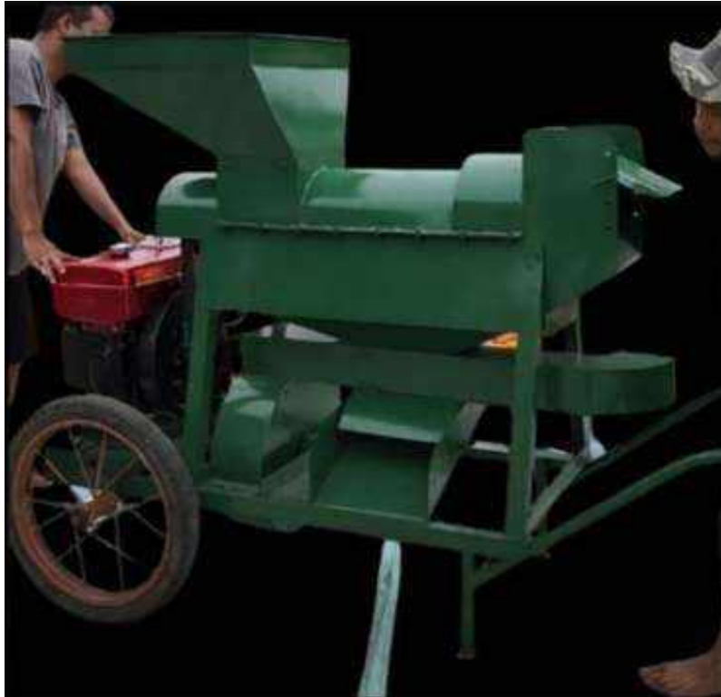
Gambar 2. Mesin diesel 8 PK dan alat pemipil jagung yang telah terpasang dan siap digunakan
