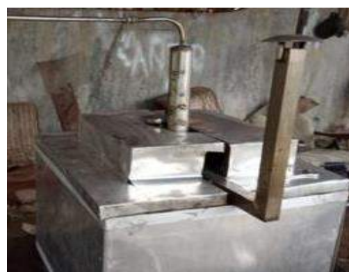
Gambar 4.4. Proses pembuatan Tungku yang dinding dilapisi semen tahan api, dan dinding luar di lapisi busa tahan panas, ditutup dengan dinding stainless steel. Berdasarkan Gambar 4.3 fungsi tabung kondensor sering digunakan untuk mengkondensasi uap menjadi cairan. Kondensor yang bekerja dengan prinsip perpindahan panas akan memindahkan panas dari satu fluida ke fluida lainnya. Di dalam kondensor terjadi dua proses perpindahan panas yaitu
