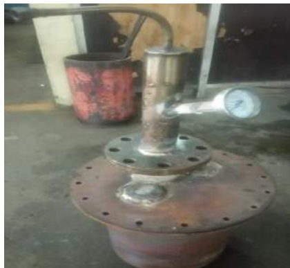
Gambar 4.2.a. Proses pengelasan alas reaktor pirolisis
