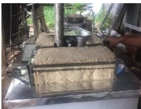
Gambar 4.4. Proses pembuatan Tungku yang dinding dilapisi semen tahan api, dan dinding luar di lapisi busa tahan panas, ditutup dengan dinding stainless steel. Berdasarkan Gambar 4.3 fungsi tabung kondensor sering digunakan untuk mengkondensasi uap menjadi cairan. Kondensor yang bekerja dengan prinsip perpindahan panas akan memindahkan panas dari satu fluida ke fluida lainnya. Di dalam kondensor terjadi dua proses perpindahan panas yaitu
