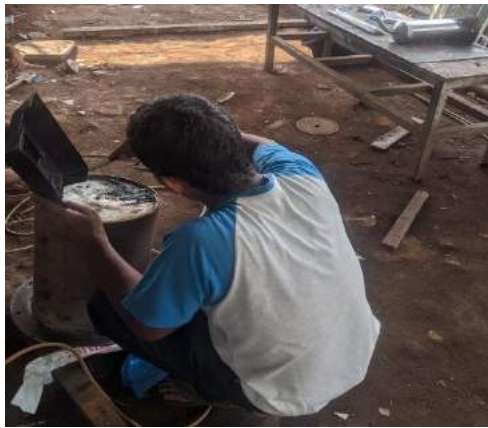
Gambar 4.2.a. Proses pengelasan alas reaktor pirolisis
