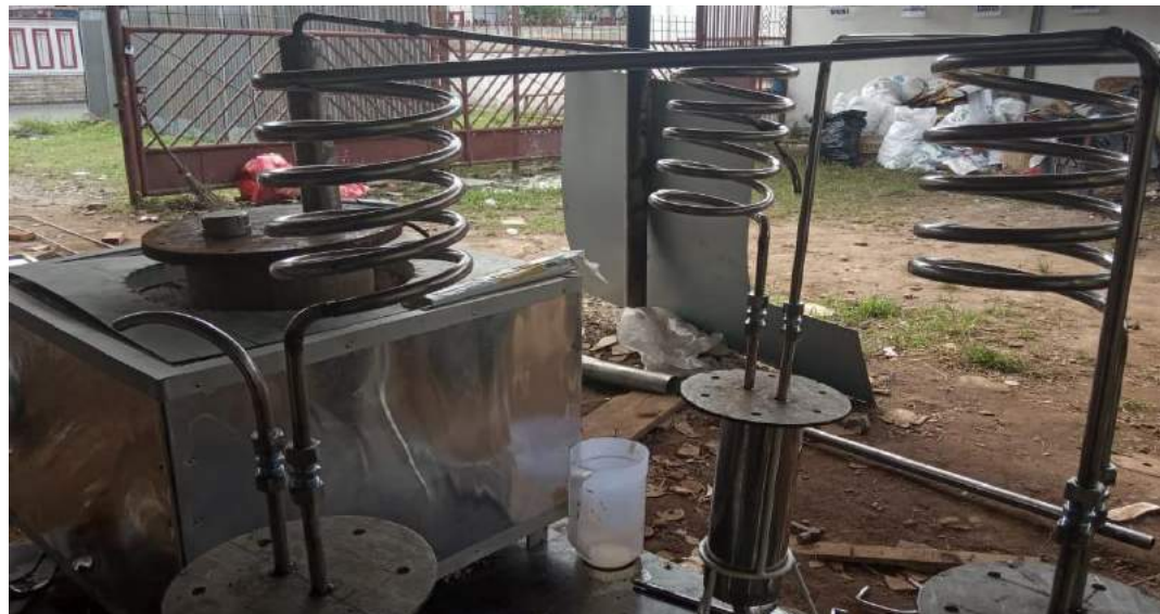
Gambar 4.3 Reaktor pirolisis dan kondensor.
