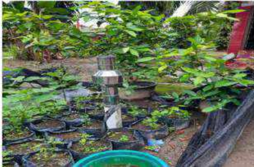
Gambar 3. Alat pengukur curah hujan omrometer
