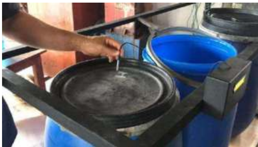
Gambar 4. Fermentor yang dilengkapi Sensor Suhu
